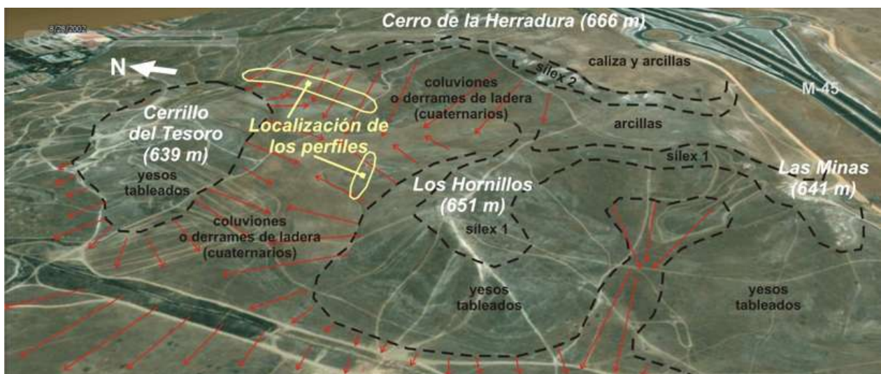
Figura 4. Cartografía geológica realizada sobre la ortofoto tridimensional del 2002 tomada del programa Google Earth. Se han representado los cerros, la geología y la localización de los perfiles con industria lítica
